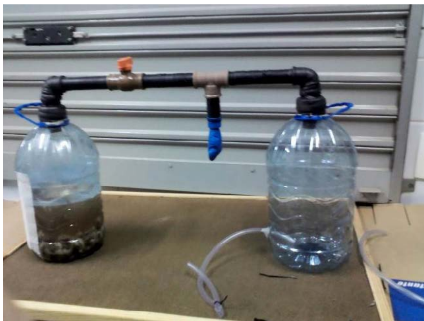
Figura 1 - Biodigestor concluído com sucesso.
